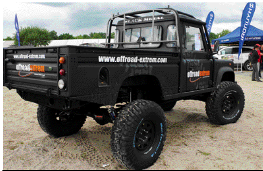
Offroad-Extrem-Landy: Volvo-Portalachsen und Fox-Fahrwerk.
